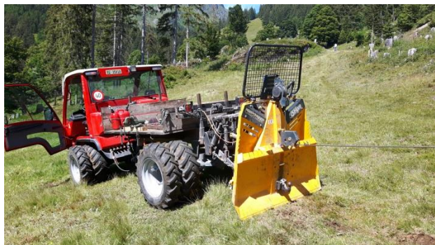
Baustämme, welche vom Borkenkäfer befallen sind, werden gefällt und mit der Seilwinde nach oben gezogen.
